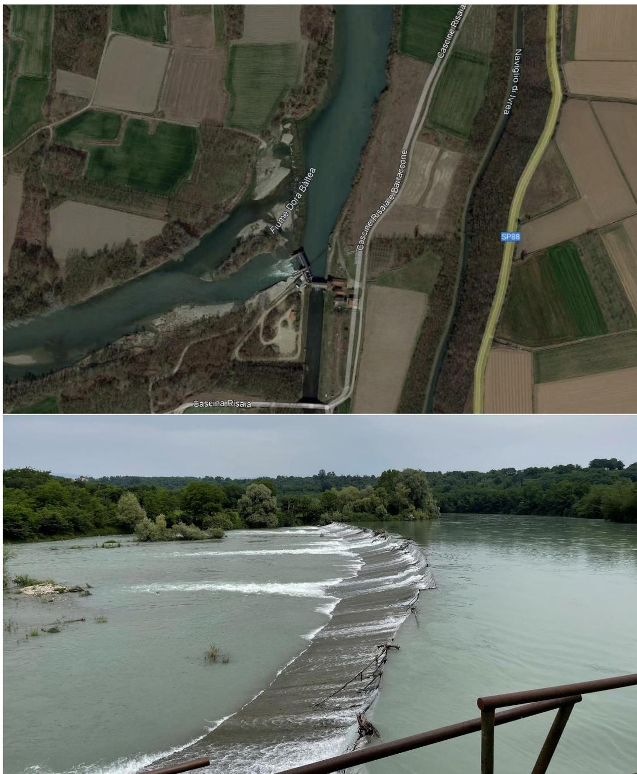
Figura 5-11: derivazione Canale Depretis; localizzazione sopra e sbarramento sotto
