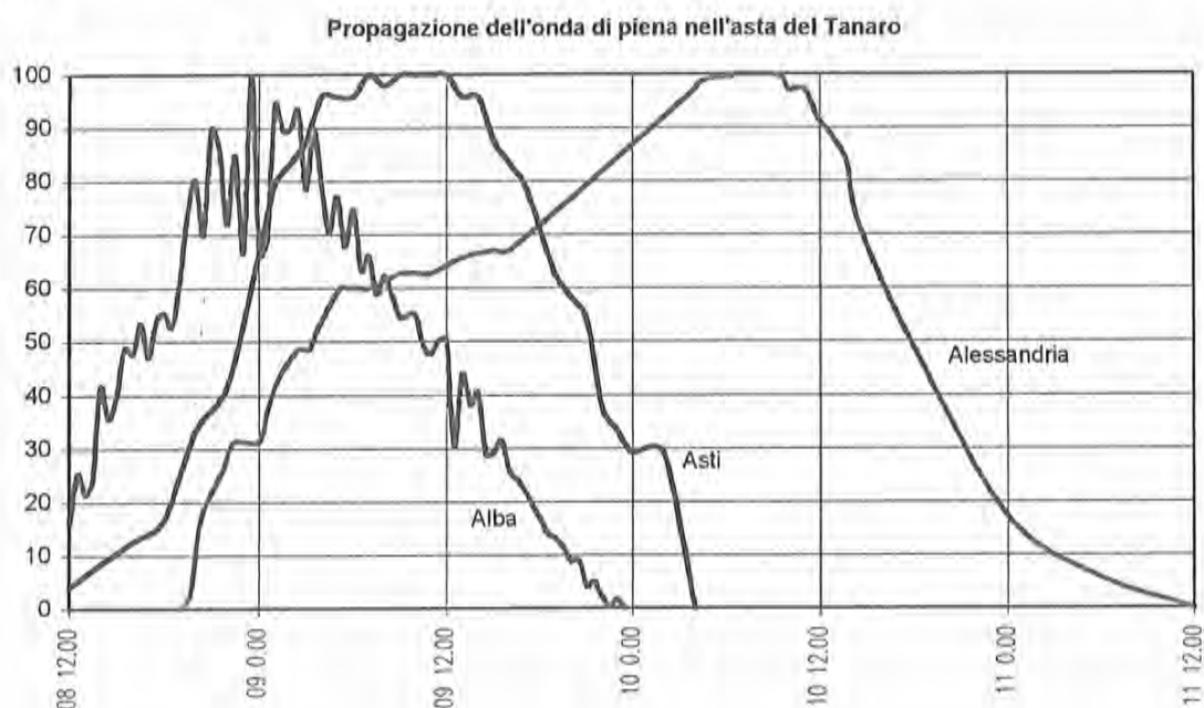
Figura 12 - Propagazione dell'onda di piena sul Tanaro (i dati delle stazioni sono normalizzati per facilitare il confronto)
