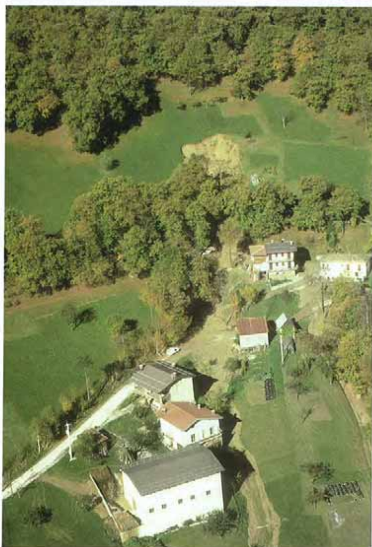
Fig. 16. Comune di Chiusa di Pesio, località Tetti Rumiano. Frana di circa 1000 m 3 innescata con movimento rotazionale a monte dell'abitato. Il materiale instabile (terreni di copertura a preponderante componente argillosa) ha dato luogo ad una colata di fango che ha interessato parzialmente un edificio senza procurare danni gravi. La colata è proseguita verso valle lungo canali della rete idrografica locale.
