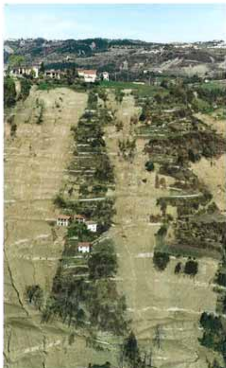
Fig. 88. Comune di Cerretto Langhe. L'immagine mostra l'ampio settore di versante coinvolto da diffuse frane superficiali.
