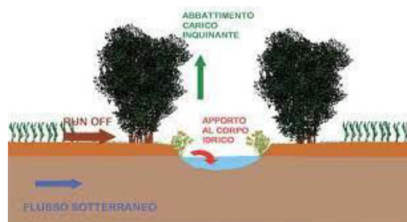
Figura 3 – Schema funzione fasce tampone (Foto da http://www.life-inhabit.it/cnr-irsa-activities/it/attivita-cnr-irsa-inhabit/rtenzione-nutrienti/fasce-riparie )
