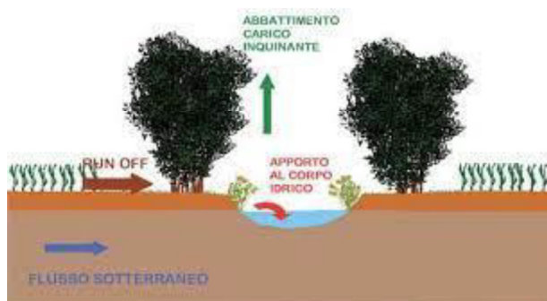
Figura 10 – Schema funzione fasce tampone ( tratto da http://www.life-inhabit.it/cnr-irsa-activities/it/attivita-cnr-irsa-inhabit/ritenzione-nutrienti/fasce-riparie )
