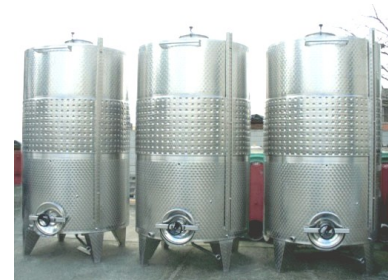
Ambiente confinato autoclave per vinificazione
