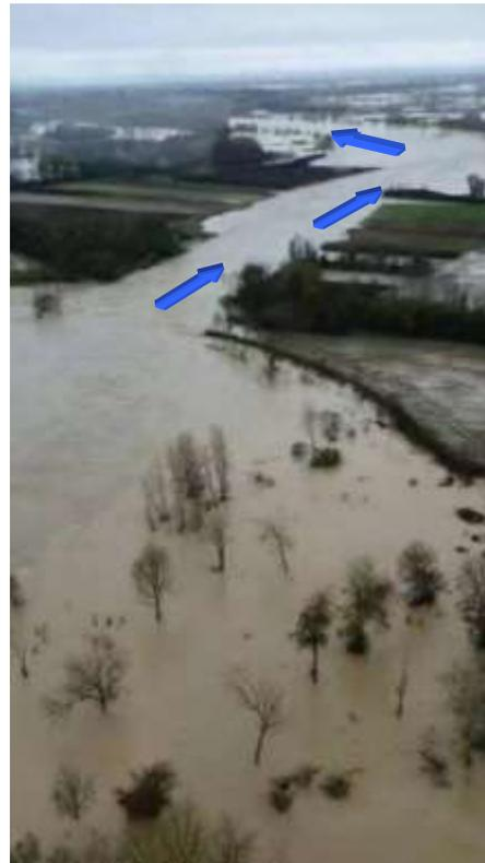
Figura 65. A sinistra la freccia indica l'imbocco del nuovo canale creatosi, a destra il riempimento dell'area di cava da parte delle acque (immagine estratta dal volo effettuato dai Vigili del Fuoco).
