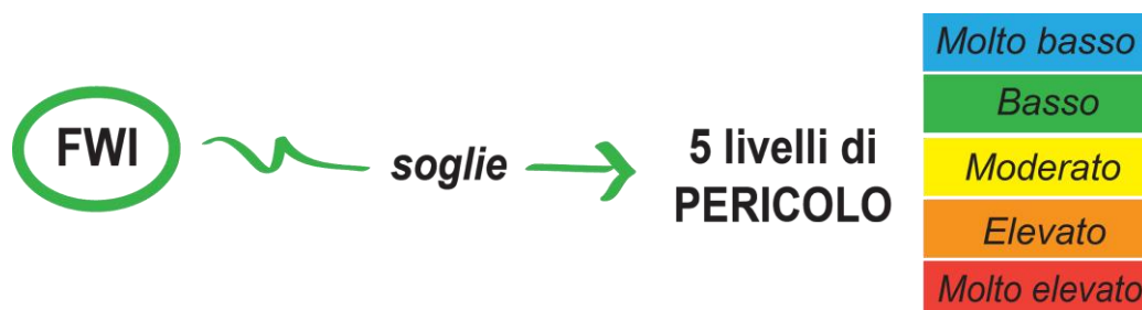
Figura 60 - schema che mostra il passaggio dal valore dell'FWI alla definizione dei livelli di pericolo
