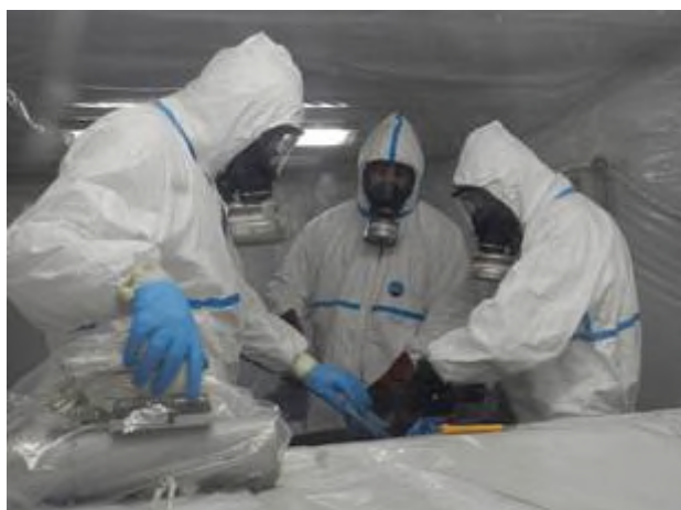
Apertura del fusto con U-235 > 10 g
