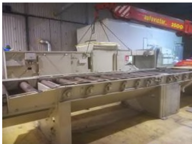
Figura 2-50 – Smontaggio macchina Pallinatrice
