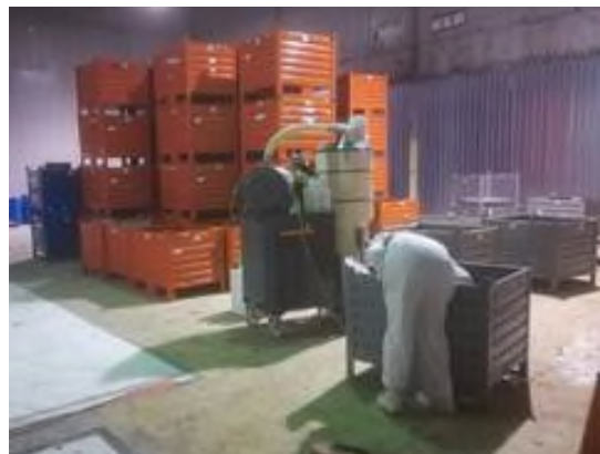
Figura 2-49 – Decontaminazione ad umido dei cassoni
