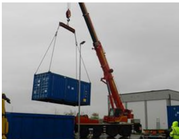
Figura 2-104 – Caricamento dei container IP-2 sul vettore di trasporto
