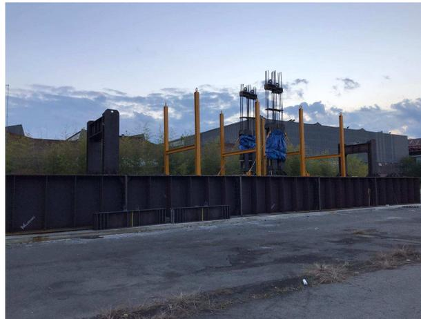
Sistema oleodinamico con 4 attuatori da 1200 kN
