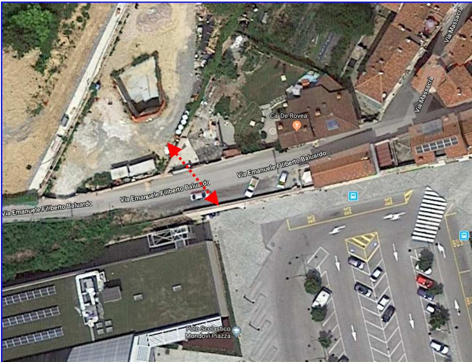
Il tunnel di collegamento (indicato nell'immagine con la linea rossa tratteggiata) permette la costruzione al suo interno di un'ampia scalinata pedonale, oltre alla possibilità di installazione di un ascensore inclinato. I due stralci hanno realizzato sostanzialmente la parte strutturale dell'opera, con palificazioni perimetrali e muri andatori, mentre sono in corso i lavori per il suo completamento, con la realizzazione dei
