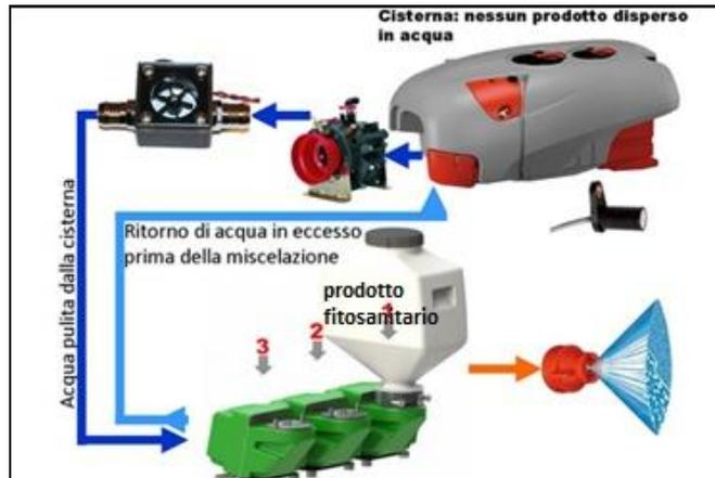
Figura 16. Esempio di sistemi di miscelazione in continuo (fonte: Mastrolab srl modificato).
