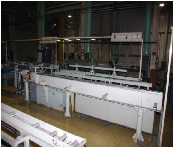
Smantellamento banco di saldatura barre connettrici (locale A110 del BLD1)
