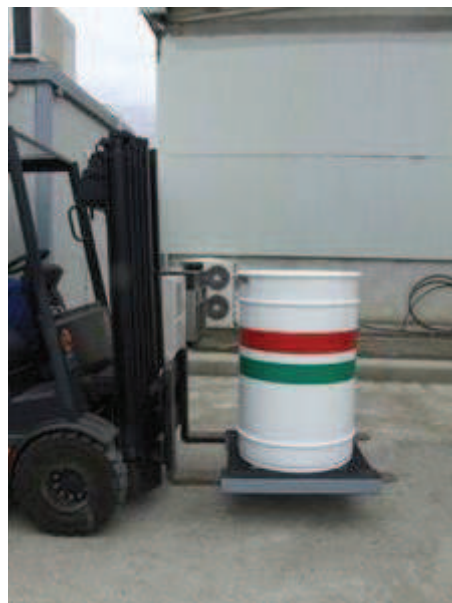
Spostamento dell'overpack alla stazione di misura
