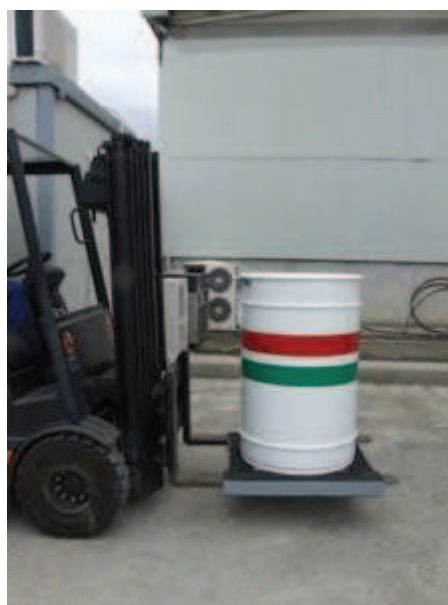
Spostamento dell'overpack alla stazione di misura
