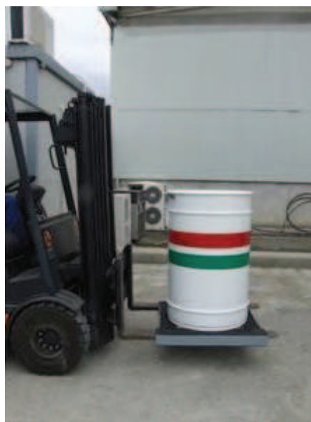
Spostamento dell'overpack alla stazione di misura
