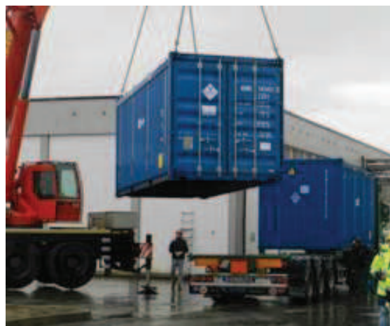
Figura 2-66 – Caricamento dei container IP-2 sul vettore di trasporto
