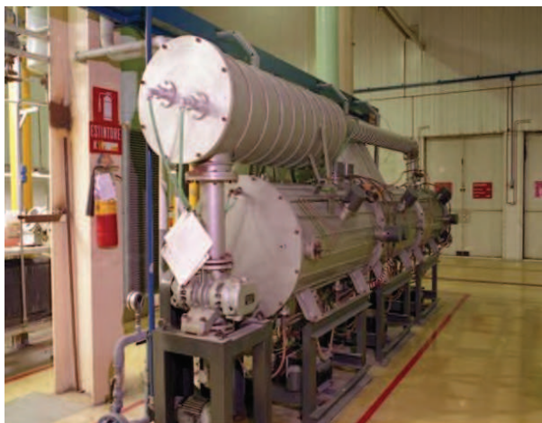
Smantellamento forno di degasaggio (locale A110 del BLD1)
