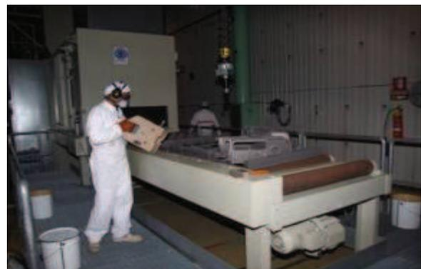
Figura 2-3 – Macchina pallinatrice
