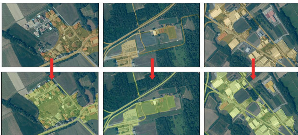
Dettaglio su tre esempi di aggiornamento del consumo di suolo (2013): espansione di area residenziale, installazione di impianti fotovoltaici a terra e nuovi capannoni e attività produttive a confronto con la mappatura del consumo del suolo al 2008.
