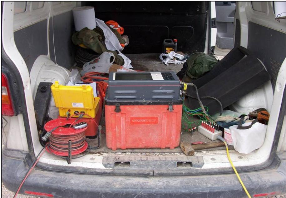
Foto 3: particolare del sismografo e della consolle per il controllo remoto dell'energizzatore
