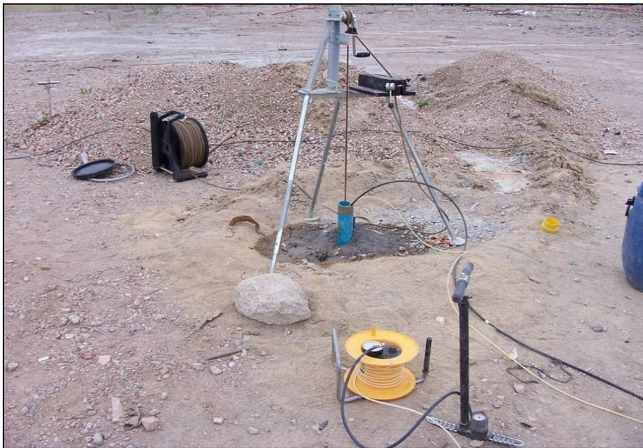
Foto 2: particolare del tripiede con argano per la movimentazione della sonda SH60
