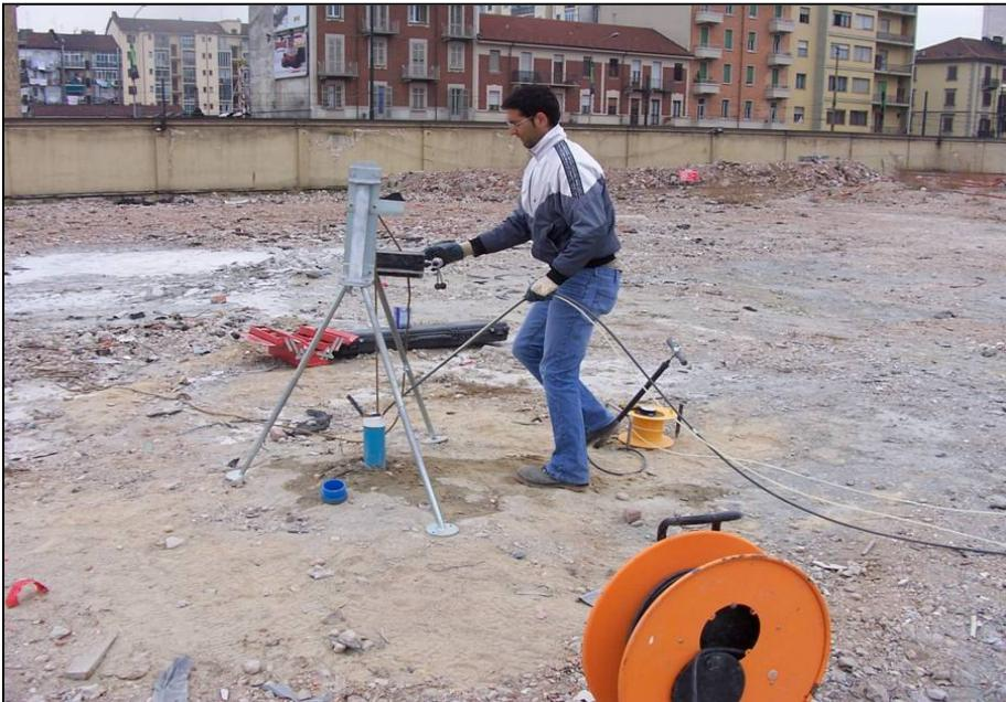
Foto 5: operazioni di movimentazione della sorgente da foro
