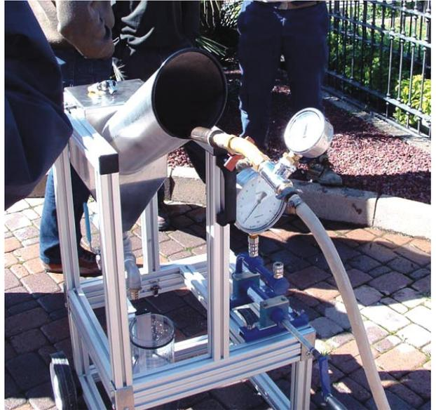
Fig. 21 – Banco prova per la determinazione della portata delle lance, dotato di banco prova manometri montato sulla struttura dell’attrezzatura, (foto G. Oggero – DEIAFA)
