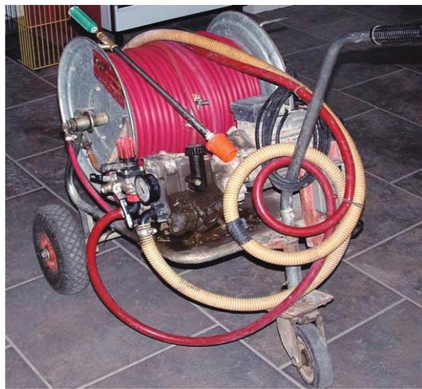
Fig. 20 - Esempi di differenti tipologie di lancia utilizzata soprattutto per trattamenti in ortofloricoltura o su appezzamenti non accessibili con le tradizionali irroratrici accoppiate al trattore (foto G. Oggero - DEIAFA)
