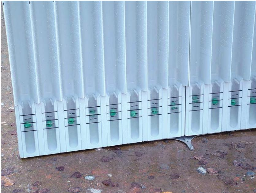
Fig. 19 – Particolare dei galleggianti che evidenziano il diagramma di distribuzione ottenuto da una prova con una irroratrice a barra (foto G. Oggero – DEIAFA)
