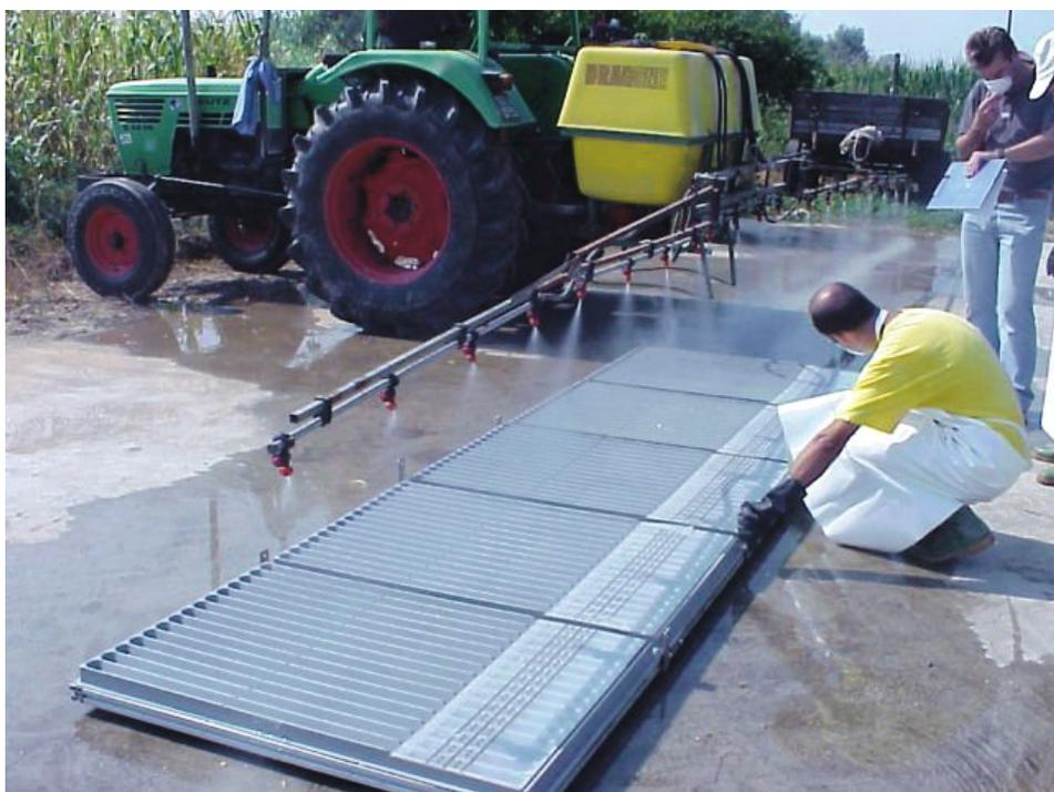
Fig. 18 - Determinazione del diagramma di distribuzione di una barra irroratrice mediante banco a canalette (foto G. Oggero - DEIAFA)
