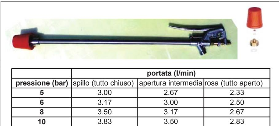
Fig. 3 - Variazione della portata dell'ugello in funzione dell'apertura del getto (lancia lunga con manopola , ugello § 1.5).
