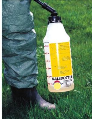
Fig. 4 – esempio di bottiglia di calibrazione
