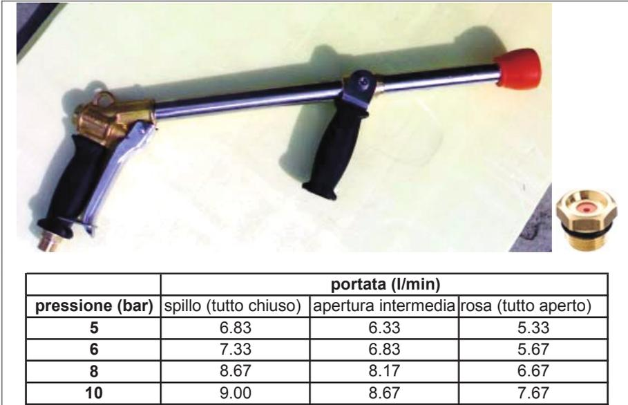
Fig. 2 - Variazione della portata dell'ugello in funzione dell'apertura del getto (lancia tipo "mitra", ugello § 2.3).
