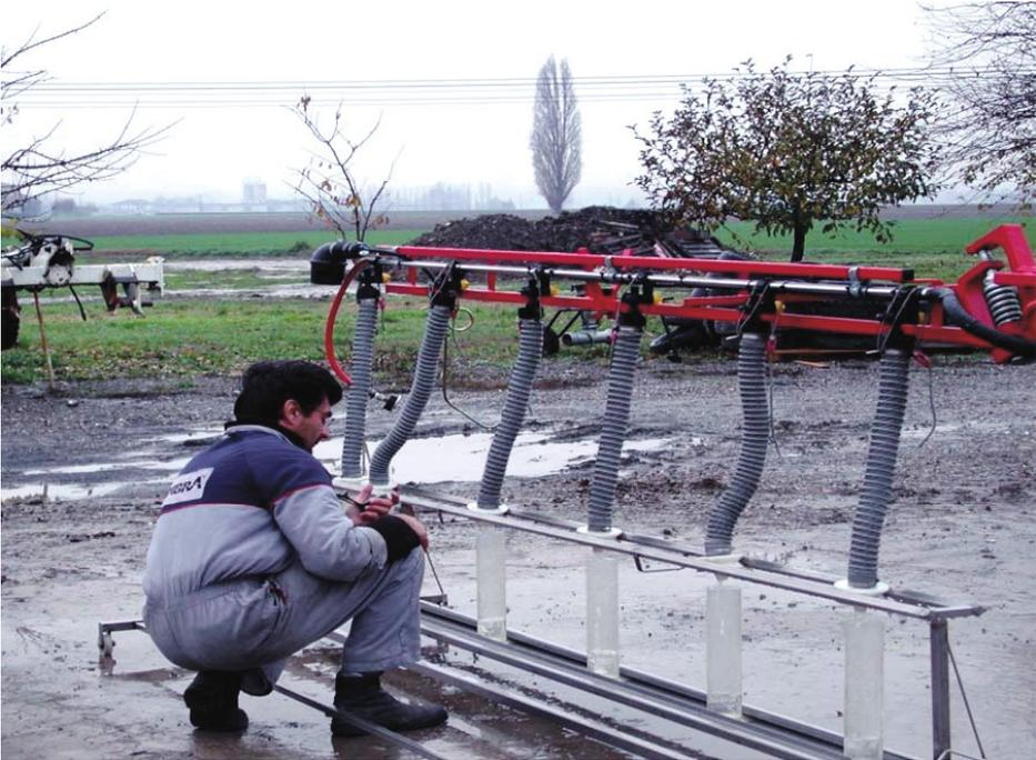
Fig. 15 – Verifica della portata degli ugelli di una barra irroratrice (foto CRPV)
