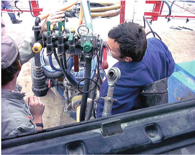
Fig. 13 – Verifica funzionalità del sistema di regolazione (foto G. Oggero – DEIAFA)
