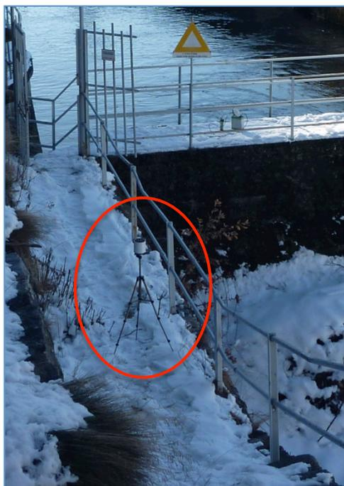
Ricevitore GNSS a tripla frequenza, Leica GS25 + CS10.
