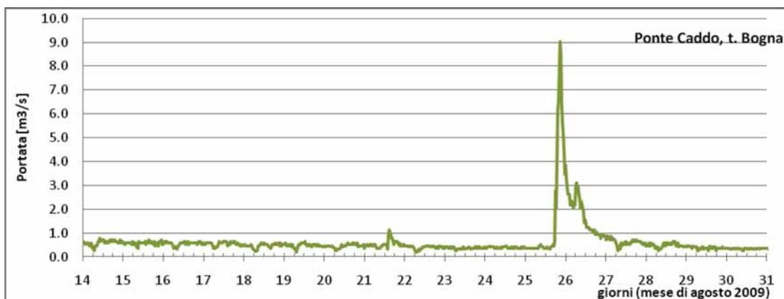
Figura 3.56: Idrogramma relativo al periodo 19/08/2009 – 31/08/2009 per la sezione di Ponte Caddo, torrente Bogna.
