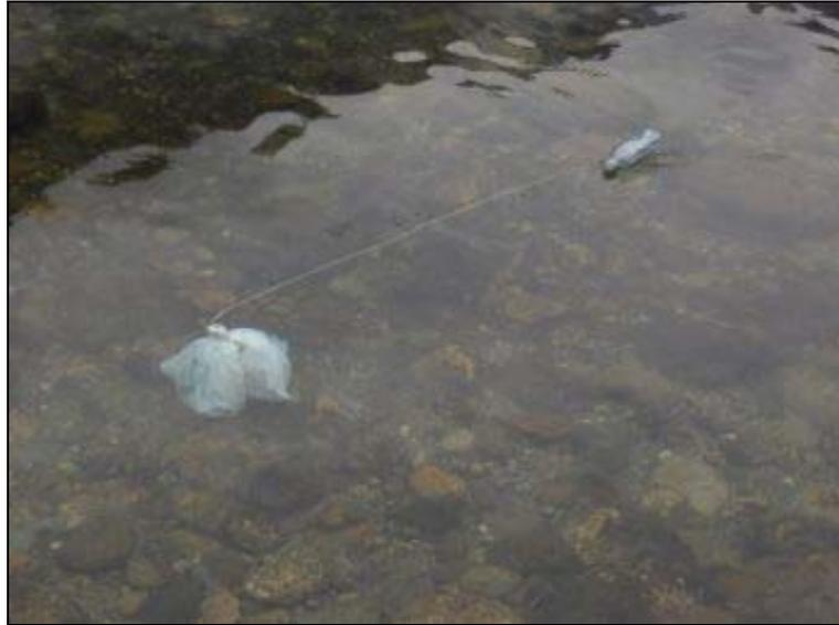
**Figura 15 – Dispositivi di campionamento in prossimità del fondo**
