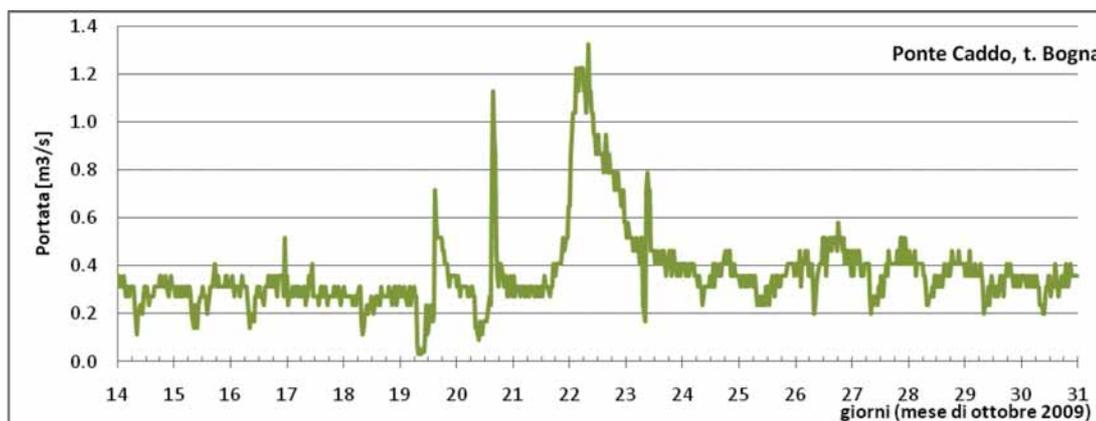
Figura 3.62: Idrogramma relativo al periodo 14/10/2009 – 30/10/2009 per la sezione di Ponte Caddo, torrente Bogna.
