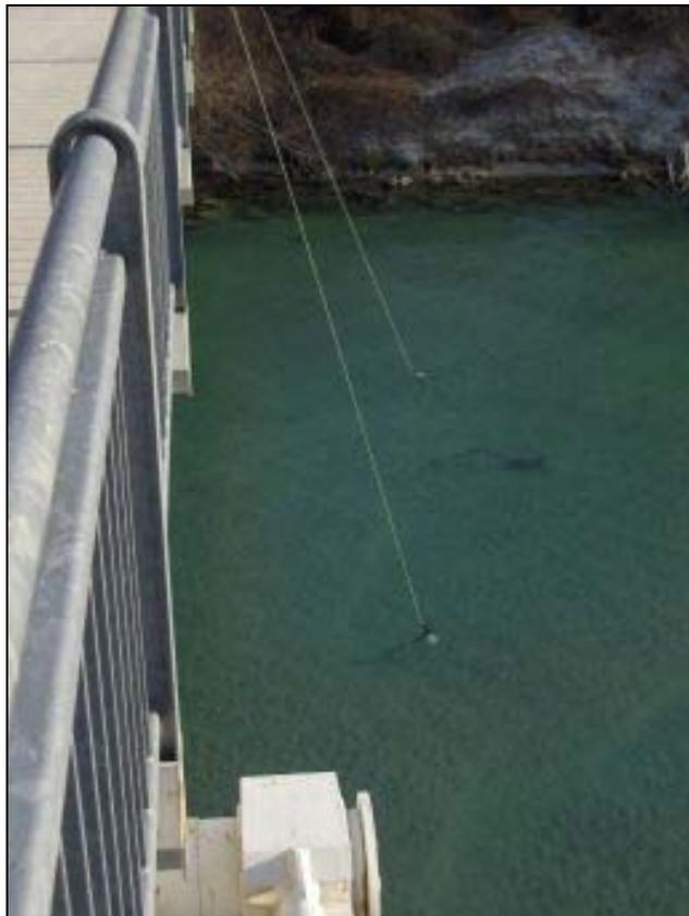
**Figura 16 – Dispositivi di campionamento nella colonna d'acqua**
