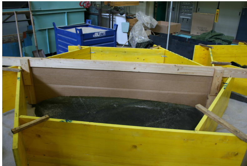
Figura 3.3: Snow pillow installato in laboratorio: fase di riproduzione del profilo. Le assi gialle sono quelle usate per confinare la sabbia durante la prova di carico.
