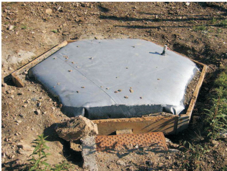
Figura 3.6: Immagine del 27 giugno 2008 (al termine della prima stagione): snow pillow installato a Lago Pilone.
