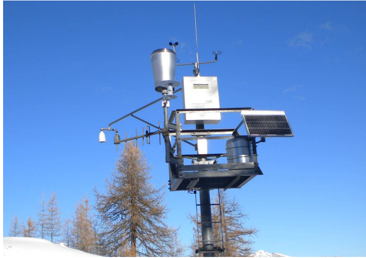
Figura 4.4: Nuovo prototipo di pluviometro riscaldato CAE-PMB20R installato a Lago Pilone in data 17 dicembre 2009. Lo strumento sostituisce quello precedentemente in funzione.
