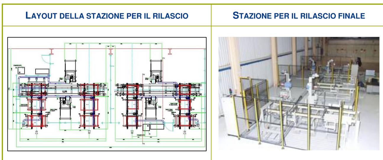
Figura 2-4 – Stazione per il rilascio finale dei materiali smantellati
