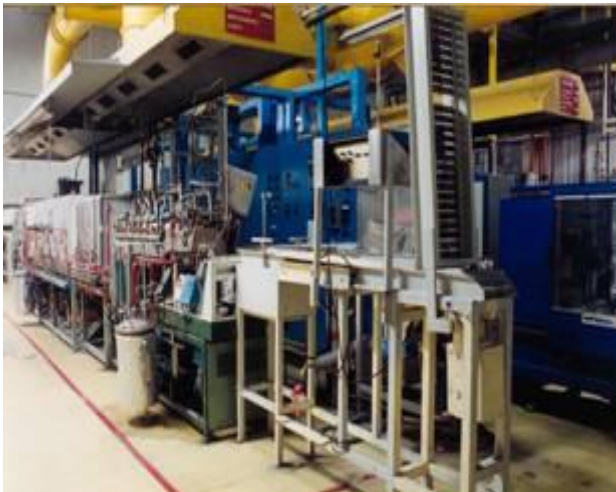
Smantellamento forni di sinterizzazione (locale A109 del BLD1)
