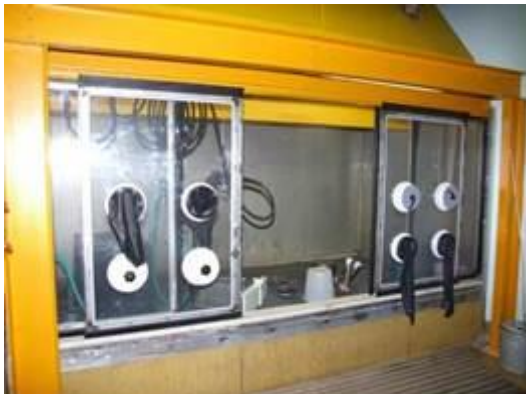
Figura 2-39 – Smantellamento della vasca di decontaminazione
