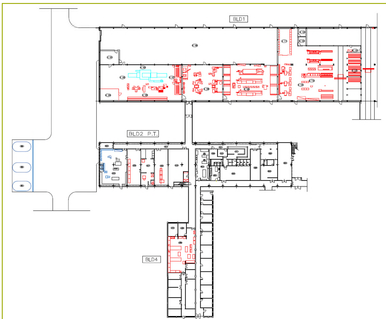
Allegato [A.1.] – Layout Aree di Lavoro (in rosso le apparecchiature smantellate, in blu le apparecchiature dell’impianto trattamento effluenti già smantellate)
