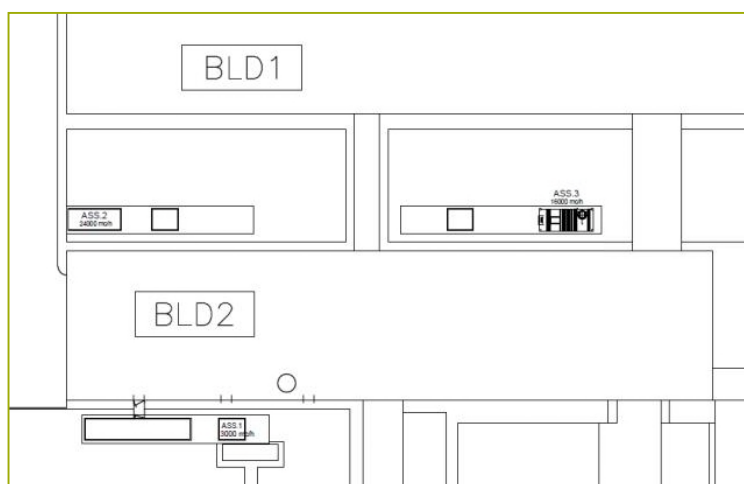
Figura 2-13 – Sistema di ventilazione di cantiere: posizionamento UTA e gruppi di filtrazione assoluta
