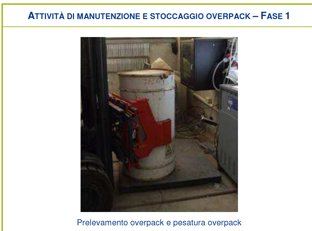
Figura 2-44 – Attività di manutenzione e stoccaggio overpack – Fase 1
