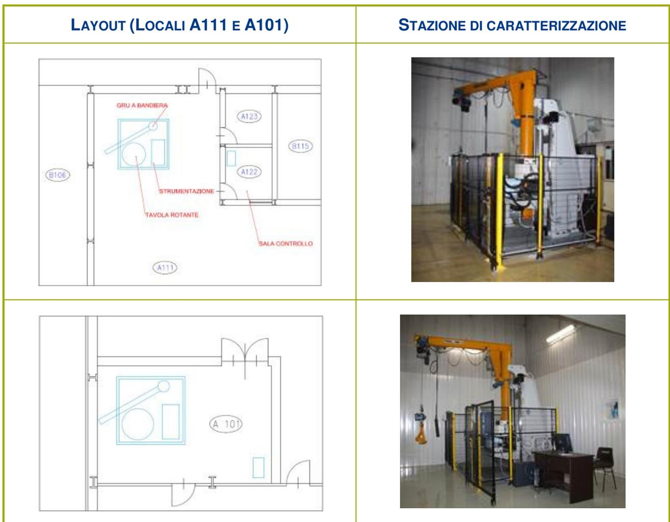
Figura 2-7 – Stazione per la caratterizzazione dei fusti di rifiuti radioattivi (locali A111 e A101)
