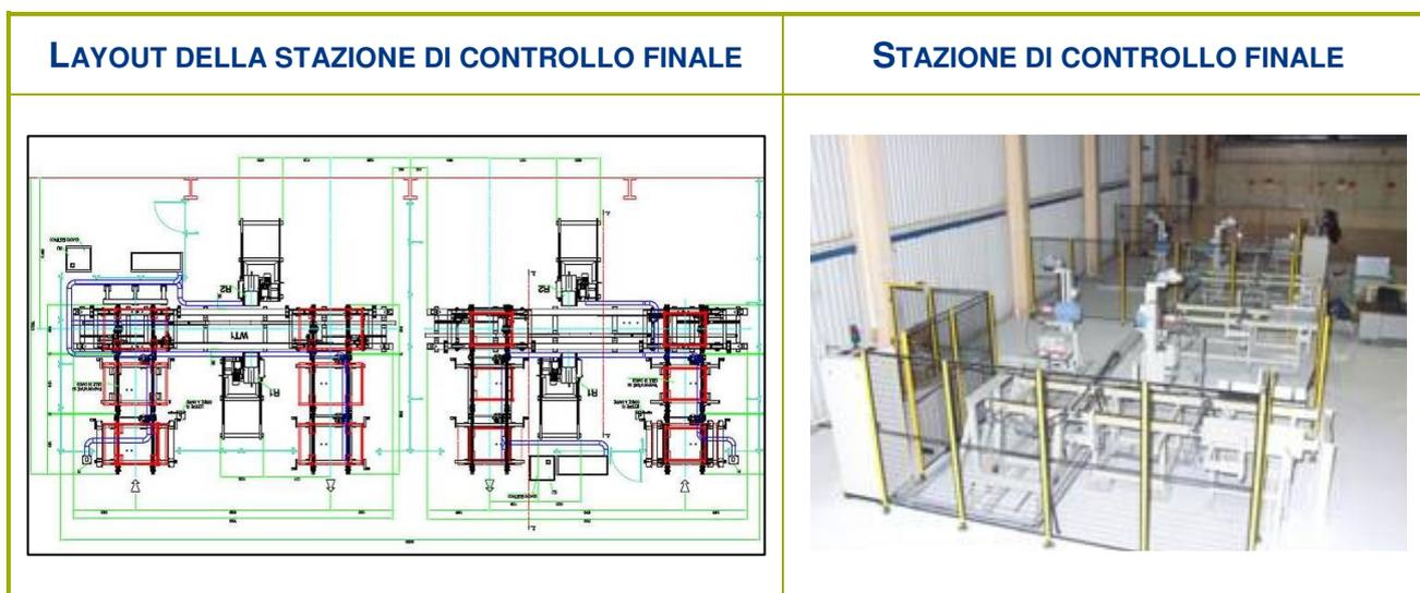
**Figura 2-6 – Stazione per il controllo finale dei materiali smantellati ai fini del loro rilascio**
