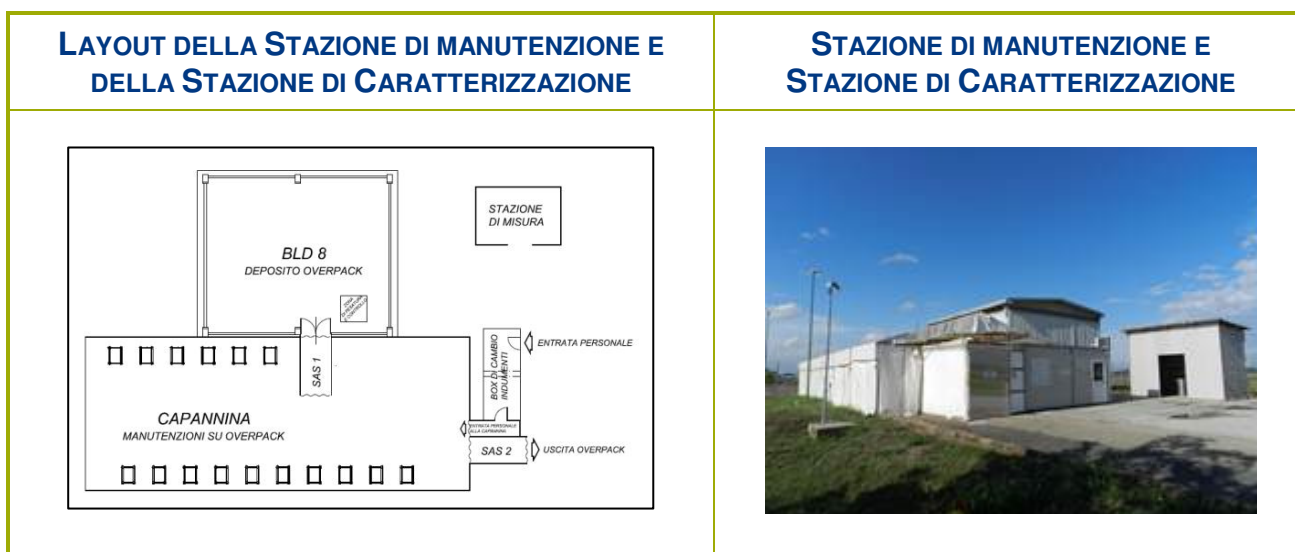
Figura 2-7 – Stazioni di manutenzione e di caratterizzazione degli overpack
