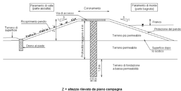
Figura 3.4 Schema tipico per diga con diaframma centrale in argilla
