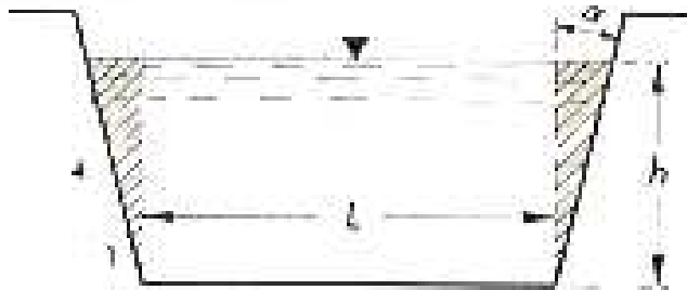
Figura 8: Stramazzo Cipoletti (Ghetti 1977, Idraulica)
