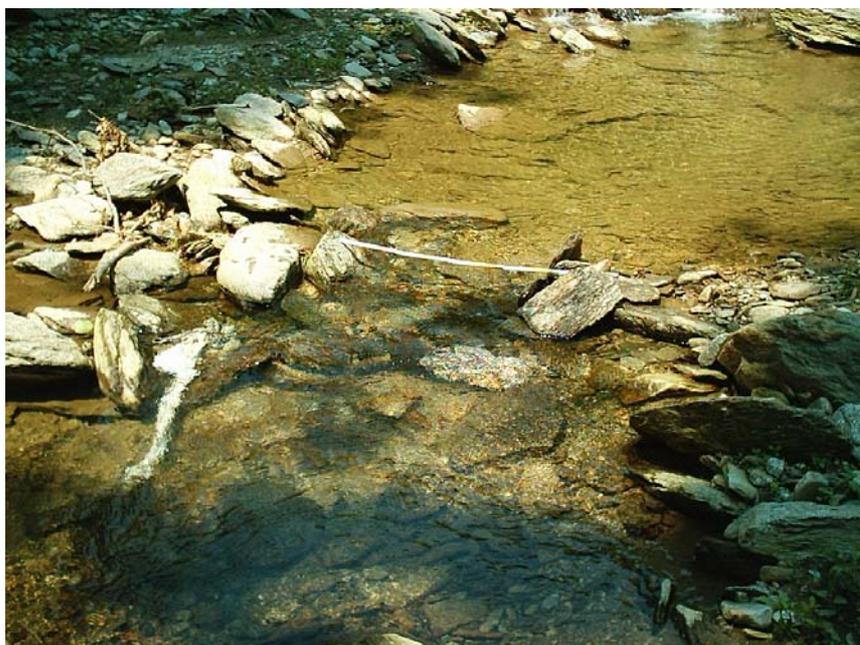
Vista sezione di misura della portata (metodo correntometrico)
