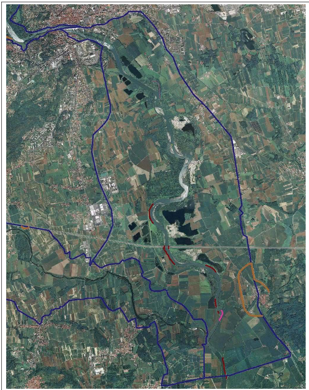
Tratto 3 con evidenziate le opere di regimazione longitudinali (scogliere in rosso e muri in rosa) e gli argini in arancio
