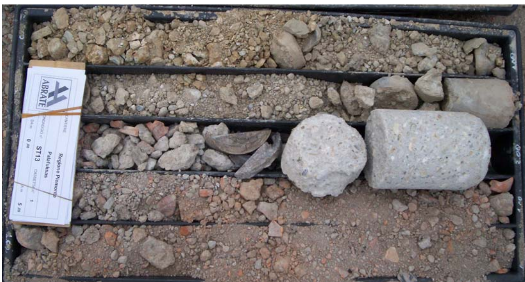
Figura 5.1: unità 0 al sondaggio ST13 (Profondità compresa tra 0-5m).
