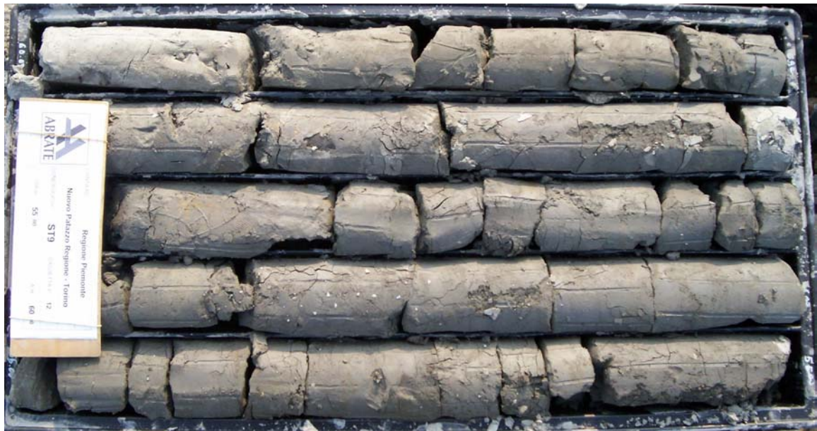
Figura 5.6: unità 3 al sondaggio ST9 (profondità compresa tra 55-60m).
