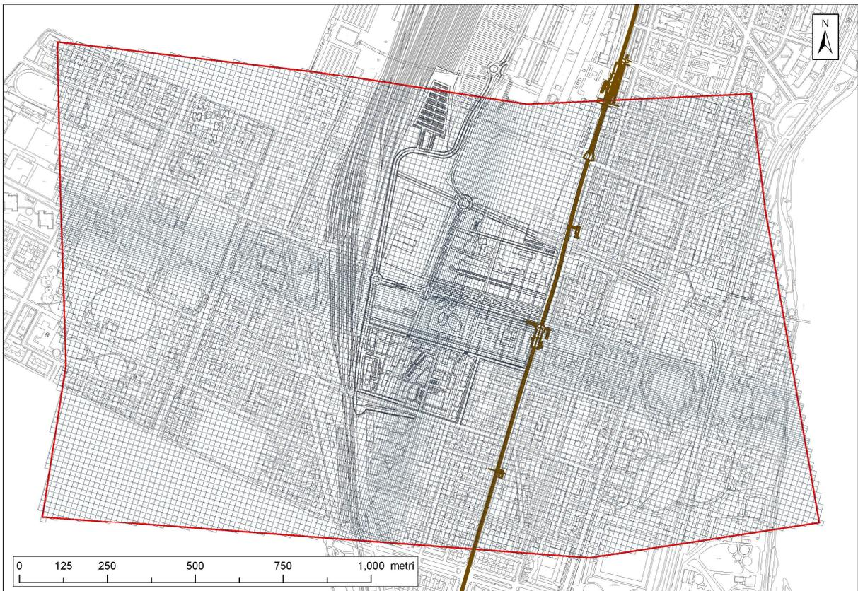
Figura 5-13: area del modello e discretizzazione del dominio di calcolo.
