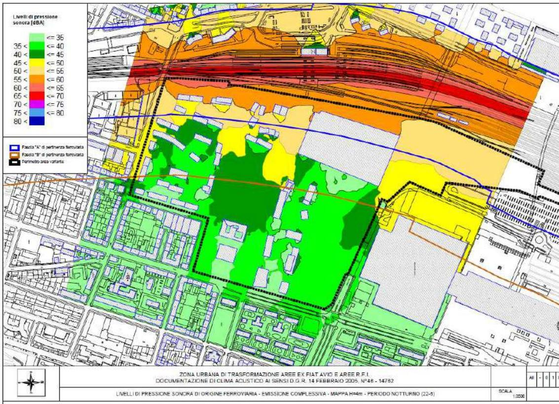
**Figura 57 – Emissioni complessive di origine ferroviaria periodo notturno**
