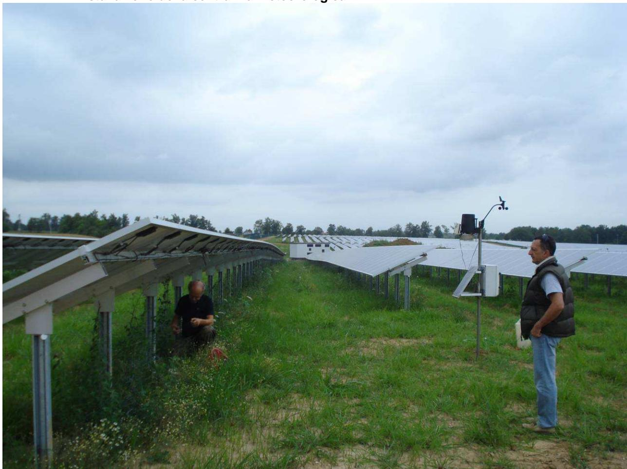
Posizione della stazione sul campo fotovoltaico, con sensori sotto il pannello (a sinistra nell'immagine) e sensori in pieno campo (solidali alla centralina meteo, a destra).
