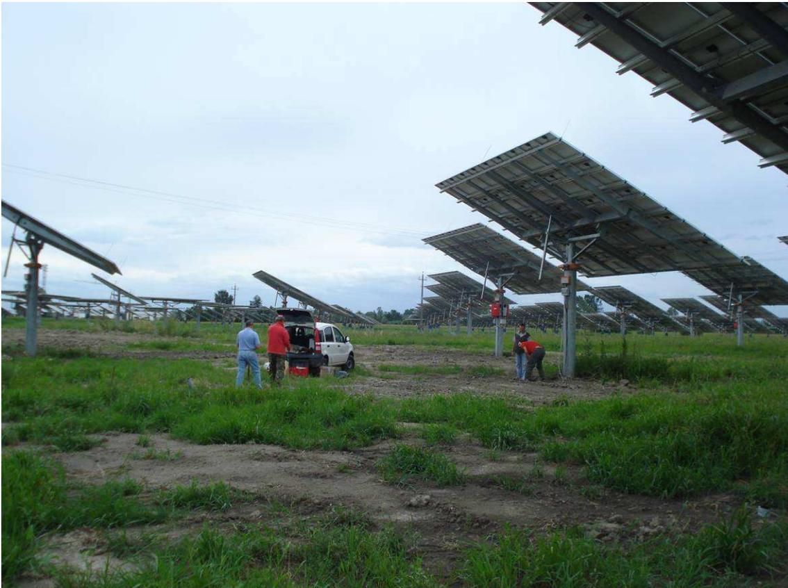
Posizionamento della stazione sul campo fotovoltaico, con sensori sotto il pannello (a destra nell'immagine) e sensori in pieno campo (presso l'auto, nell'immagine)
