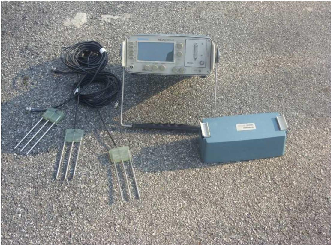
**Figura n.4 : Apparecchiatura TDR Tektronix 1502c.**
