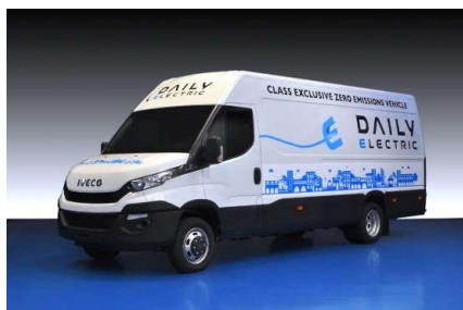
Van con massa a terra di 5,6 t, autonomia da 70 a 200 km a seconda nel numero di pacchi di batterie (1, 2 o 3).
