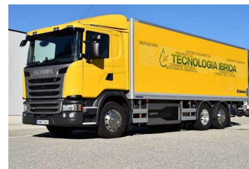
Questo autocarro adotta un powertrain ibrido da 9,0 litri Euro 6 alimentato mediante biodiesel e HVO. È in grado di viaggiare in modalità esclusivamente elettrica per alcuni chilometri.
