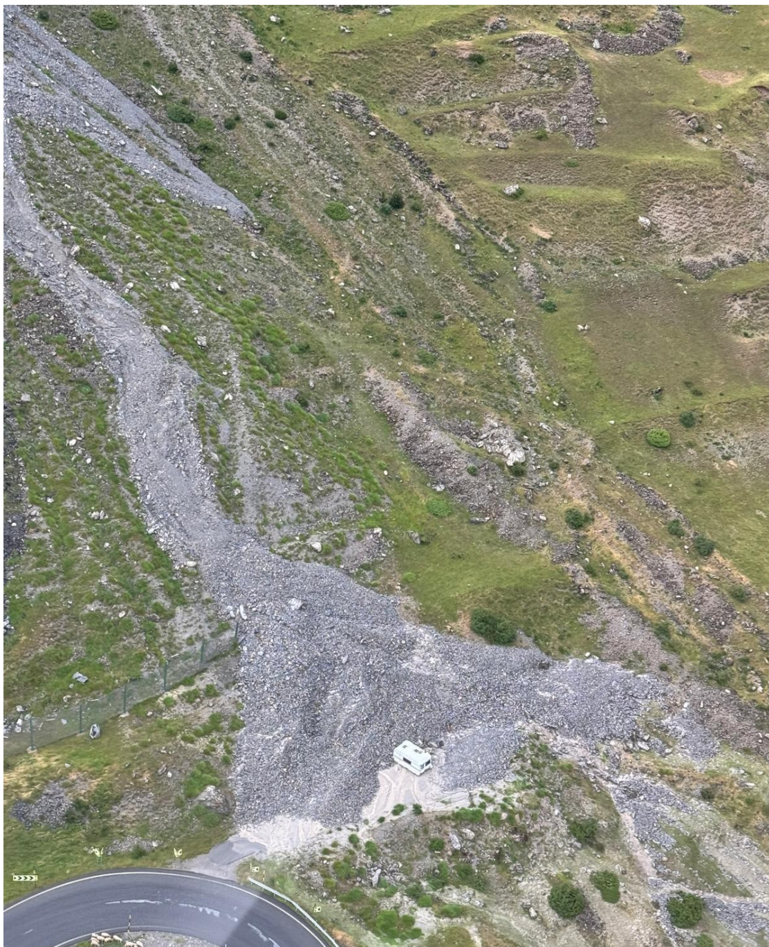
Figura 34. Colata detritica nei pressi di un tornante della Strada Statale n.21. Fonte Comune di Argentera
