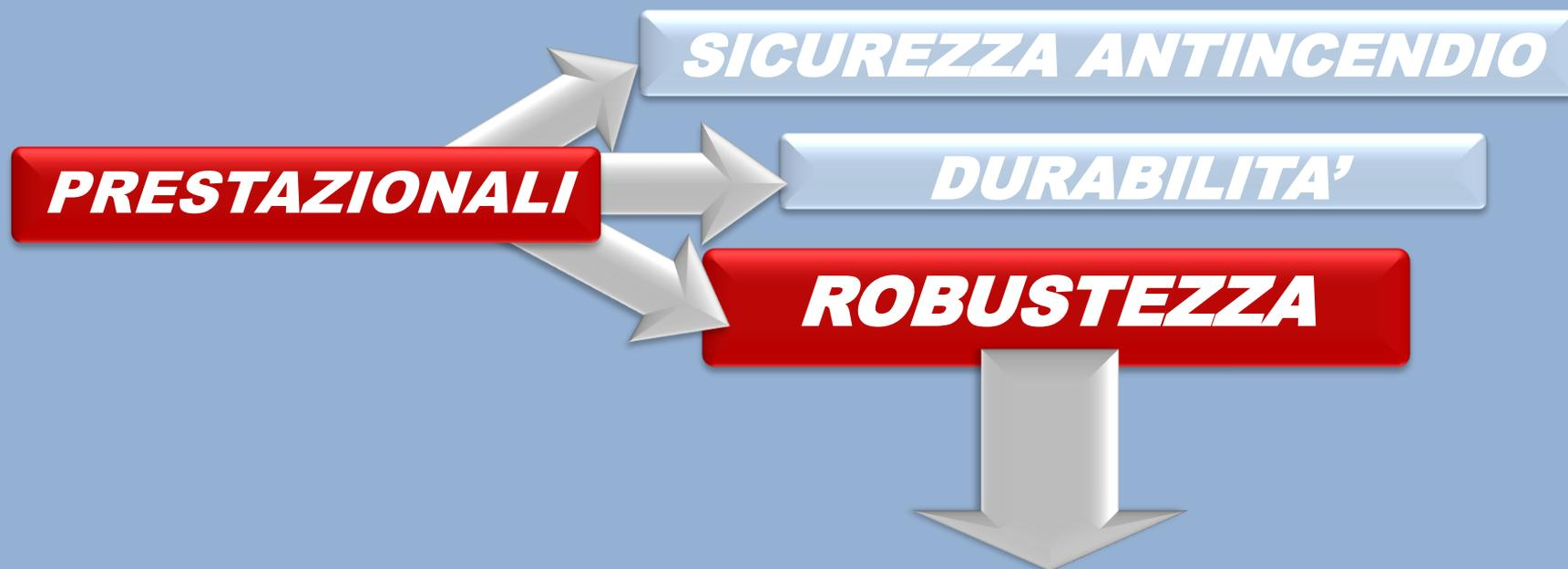
**LA ROBUSTEZZA NEI CONFRONTI DI AZIONI ECCEZIONALI È LA CAPACITÀ DI EVITARE DANNI SPROPORZIONATI RISPETTO ALL'ENTITÀ DELLE CAUSE INNESCANTI QUALI INCENDIO, ESPLOSIONI, URTI, SVIO.**
