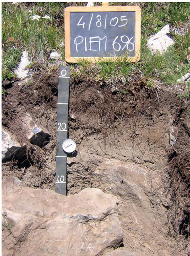
**Orizzonte Ah:** 0 - 13 cm; umido; colore bruno grigiastro molto scuro (2,5Y 3/2); tipo colore ossidato; screziature assenti; tessitura franco sabbiosa; scheletro 40 %, di forma irregolare, con diametro medio di 120 mm e diametro massimo di 400 mm, non alterato; struttura granulare media di grado moderato; macropori comuni, con dimensioni medie 1-5 mm; radici 60/dmq, con dimensioni medie di 1 mm e dimensioni massime di 2 mm, orientate in piani
