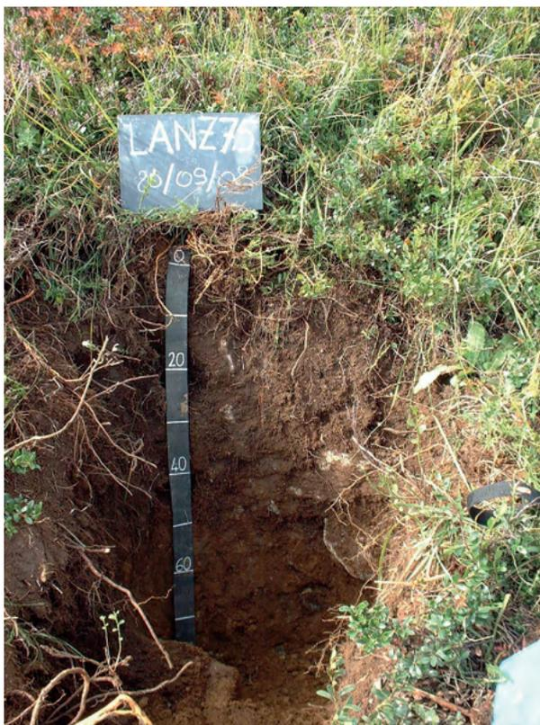
**Orizzonte Ah:** 0 - 10 cm; umido; colore nero (10YR 2/1); tipo colore ossidato; screziature assenti; tessitura franco sabbiosa; scheletro 3 %, di forma irregolare, con diametro medio di 5 mm e diametro massimo di 15 mm, leggermente alterato; struttura granulare fine di grado debole; radici 60/dmq, con dimensioni medie di 1 mm e dimensioni massime di 6 mm, orientate in piani obliqui; radicabilità 90%; debolmente resistente; cementazione molto debole; non adesivo; non plastico;
