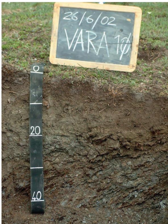
**Orizzonte Ah:** 0 - 5 cm; umido; colore grigio molto scuro (5Y 3/1); tipo colore ossidato; screziature assenti; tessitura franca; scheletro comune, di forma irregolare, con diametro medio di 30 mm e diametro massimo di 80 mm, leggermente alterato; struttura granulare fine di grado debole; radici molte, con dimensioni medie di 1 mm e dimensioni massime di 2 mm, orientate in piani orizzontali; radicabilità 80%; debolmente resistente; cementazione molto debole; non adesivo; debolmente
