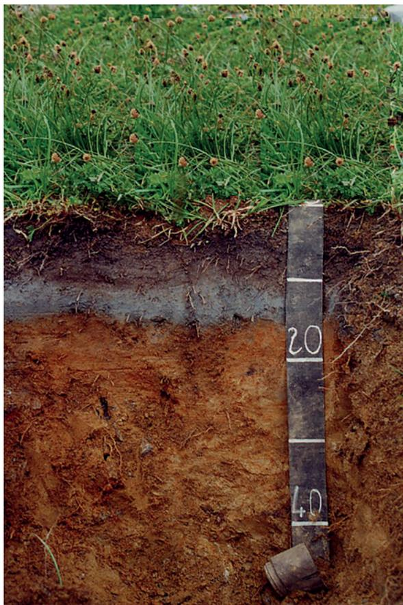
**Orizzonte Ah:** 0 - 4 cm; umido; colore grigio molto scuro (10YR 3/1); tipo colore ossidato; screziature assenti; tessitura sabbiosa; scheletro 5 %, di forma irregolare; struttura granulare media di grado debole; radici 50/dmq, con dimensioni medie di 1 mm e con dimensioni massime di 1 mm; radicabilità 90%; resistenza incoerente; cementazione molto debole; non calcareo; concentrazioni principali assenti; pellicole principali assenti; limite inferiore abrupto e lineare.
