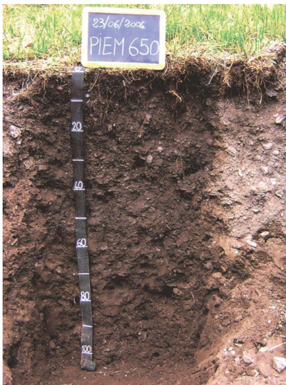
**Orizzonte Ah:** 0 - 13 cm; secco; colore grigio molto scuro (2,5Y 3/1); tipo colore ossidato; screziature assenti; tessitura franca; scheletro 20 %, di forma irregolare, con diametro medio di 25 mm e diametro massimo di 50 mm, leggermente alterato; struttura incoerente; macropori comuni, con dimensioni medie minori di 1 mm; radici 45/dmq, con dimensioni medie di 1 mm e dimensioni massime di 2 mm, orientate in piani obliqui; radicabilità 80%; resistenza incoerente; cementazione molto
