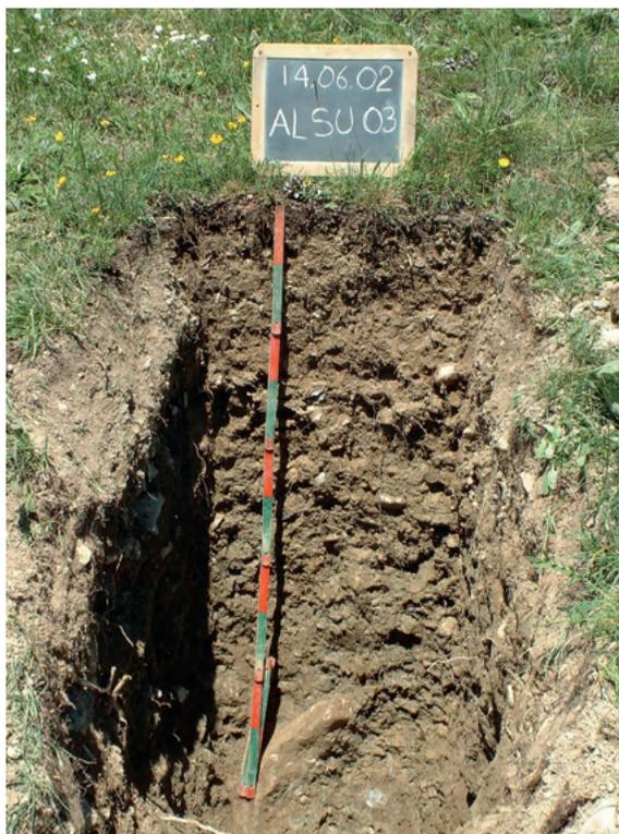
**Orizzonte A1:** 0 - 18 cm; secco; colore bruno olivastro (2,5Y 4/3); tessitura franca; scheletro 10 %, di forma subarrotondata, con diametro medio di 25 mm e diametro massimo di 50 mm, non alterato; struttura granulare media di grado moderato; macropori abbondanti, con dimensioni medie 1-5 mm; radici 60/dmq, con dimensioni medie di 1 mm e dimensioni massime di 3 mm, orientate in tutte le direzioni; debolmente resistente; cementazione molto debole; debolmente adesivo; debolmente
