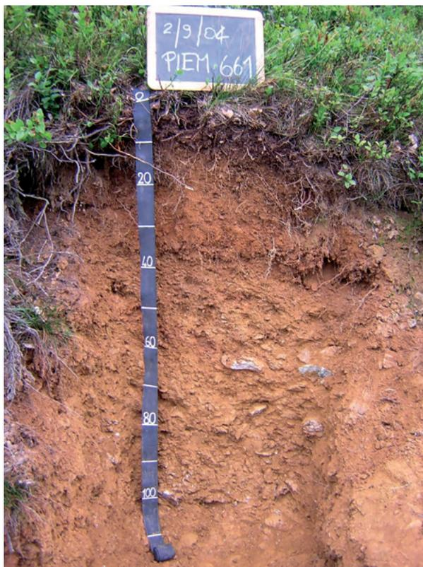
**Orizzonte A:** 0 - 7 cm; umido; colore bruno giallastro scuro (10YR 4/4); tipo colore ossidato; screziature assenti; tessitura franca; scheletro 2 %, di forma irregolare, con diametro medio di 10 mm e diametro massimo di 40 mm, leggermente alterato; struttura granulare media di grado debole; macropori comuni, con dimensioni medie minori di 1 mm; radici 70/dmq, con dimensioni medie di 1 mm e dimensioni massime di 3 mm, orientate in piani obliqui; radicabilità 90%;
