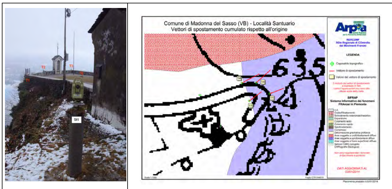
Figura 1 – Madonna del Sasso (VCO). Frana di località Santuario/Rupe. Strumentazione topografica e punti di misura (a sinistra). Vettori di spostamento sul piano xy in occasione della lettura topografica del 3/01/2014, rispetto alla lettura di origine del febbraio 2006 (a destra).
