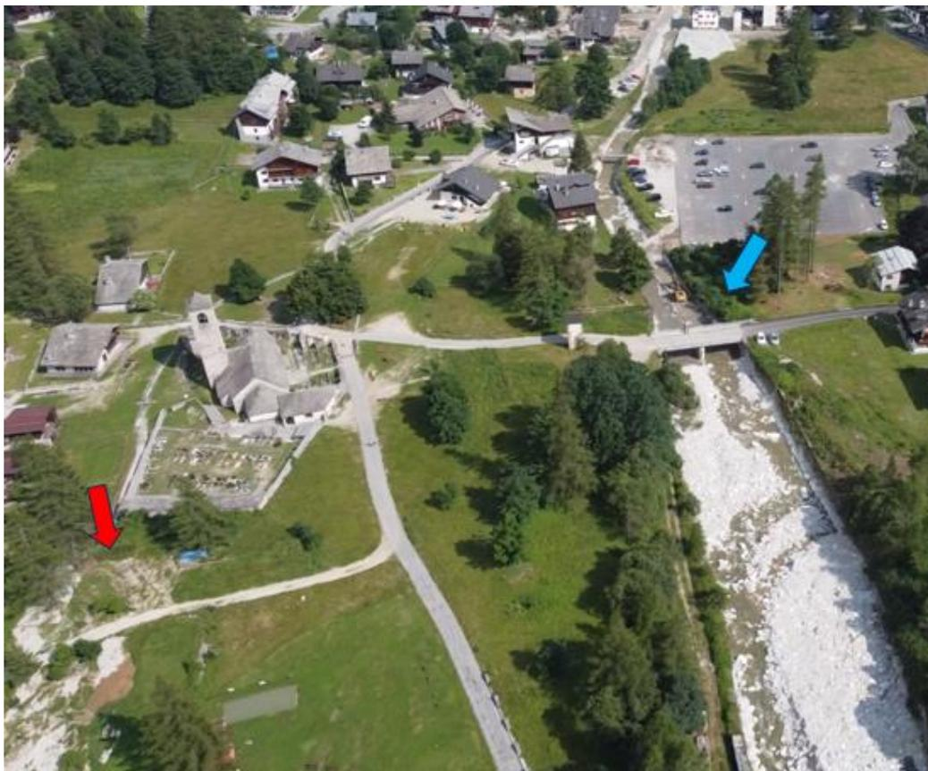
Figura 62 - Ripresa dall'alto che mostra come la deposizione del materiale grossolano si sia prevalentemente arrestata in prossimità dell'area cimiteriale (freccia rossa). Si noti, sulla destra, come l'alveo del rio Tambach sia riuscito a contenere la portata di piena; tuttavia, subito a valle del ponte, l'alveo subisce un significativo restringimento della sezione di deflusso (freccia blu) e a valle iniziano ad apparire gli effetti della deposizione della piena torrentizia.
