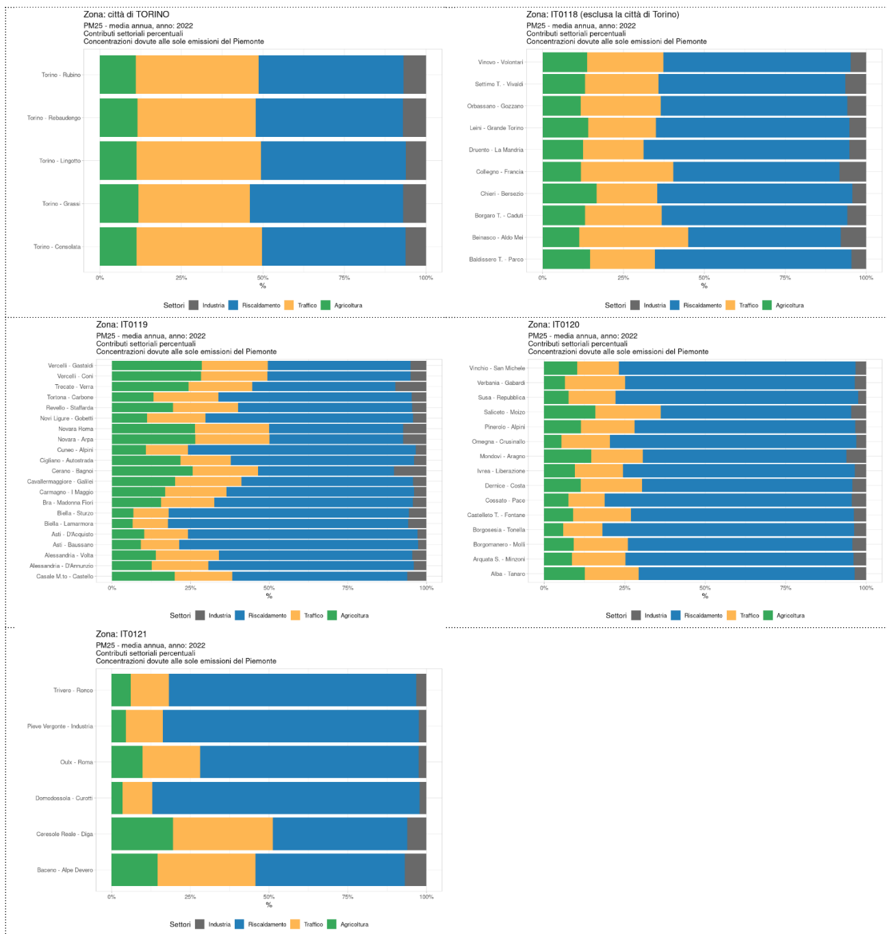
Figura 6.107: Contributo percentuale alle concentrazioni medie annue di particolato PM2.5 presso i punti di misura di SRRQA da parte dei comparti emissivi individuati per il source apportionment. Le percentuali sono calcolate rapportando il contributo di ciascun settore alla concentrazione totale dovuta al solo contributo delle sorgenti localizzate in Piemonte
