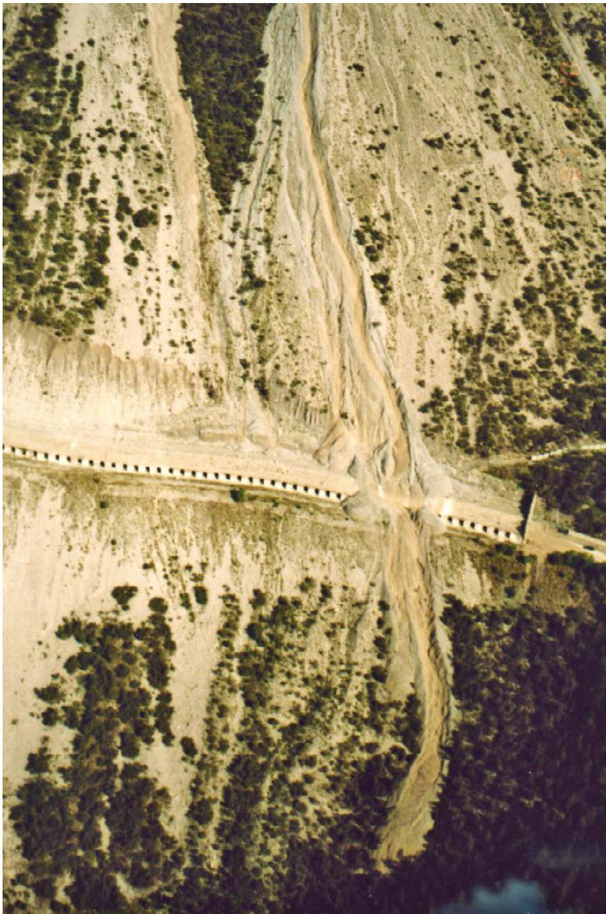
elevate portate di torbida, le quali a loro volta incrementano l'erosione delle sponde e del fondo alveo. I flussi possono arrivare a valle sotto forma di vere e proprie **frane di detriti** solidi con vegetazione e acqua. Questo è il caso delle frane cosiddette di **debris flow**, un **colamento veloce incanalato** che prende forma lungo ripide aste torrentizie.
