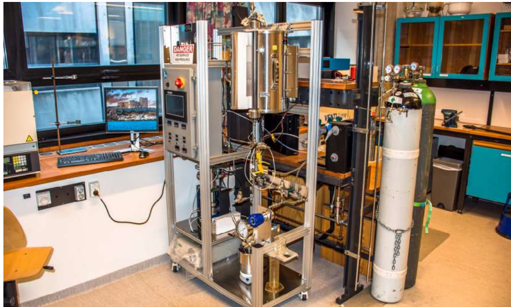
Il reattore idrotermale a fluido continuo per l'interazione acqua di mare-Co2 e roccia basaltica a diverse condizioni di temperatura e pressione (diritti d'autore: Mauro Passarella, Università di Bergen, Norvegia)
