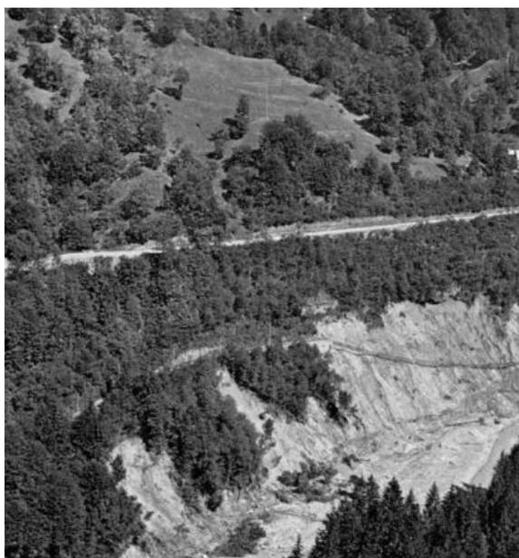
Foto 17.4 : Sede ferroviaria distrutta per l'erosione della sponda lungo il Melezio occidentale (fonte: ANSELMO, 1980).
