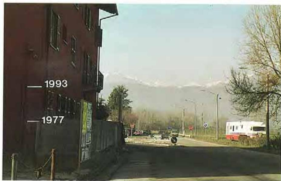
Foto 22 - Banchette (TO): altezze delle acque di inondazione durante gli eventi del 1977 e del 1993.
