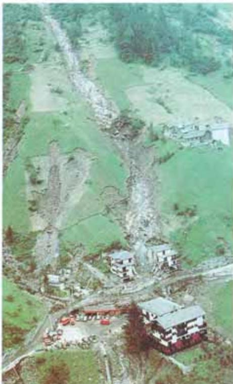
Fig. 66. Lombardia, Valtellina, Loc. Val Tartano (17-7-1987). Danni gravissimi ad edifici con numerose vittime a seguito di colata rapida incanalata di materiale derivante da frane di mobilizzazione della coltre detritica (Catenacci, 1993).
