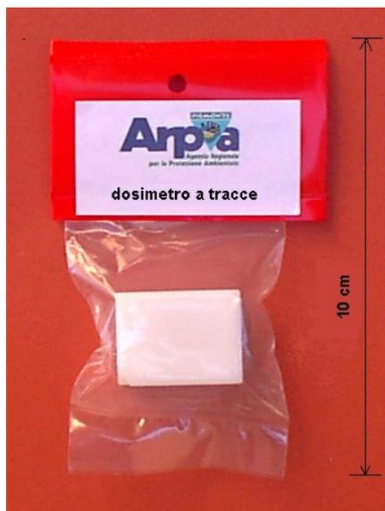
**Figura 2. Esempio di dosimetro a tracce (ARPA Piemonte). Utilizzando questa tipologia di dosimetri occorre fare attenzione che la busta trasparente in cui è contenuto il dosimetro NON venga danneggiata**
