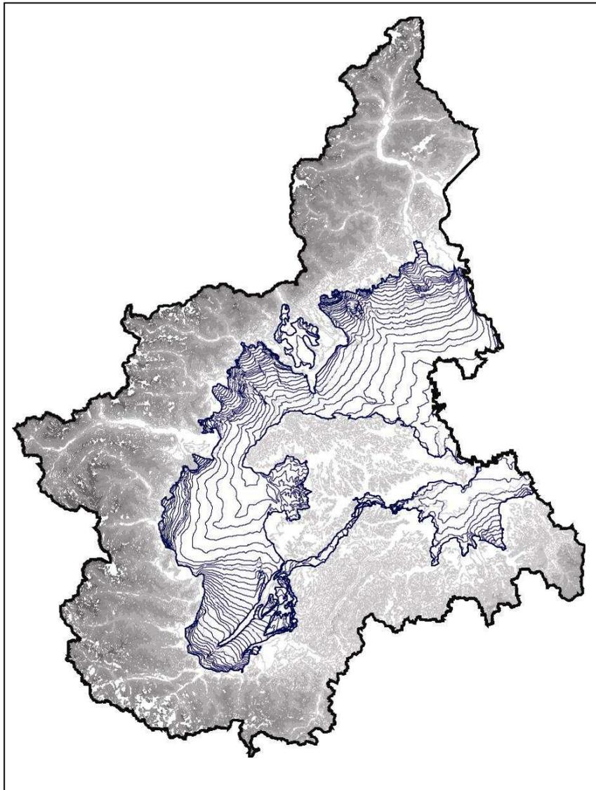
Carta delle isopiezometriche della falda superficiale (cfr. CD-ROM - allegato II.1)
