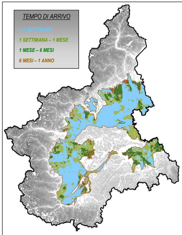
Il tempo di arrivo in falda è calcolato assumendo le massime condizioni di sicurezza nella valutazione della vulnerabilità, cioè saturazione della zona non satura e gradiente idraulico unitario ( $i = 1$ ).
