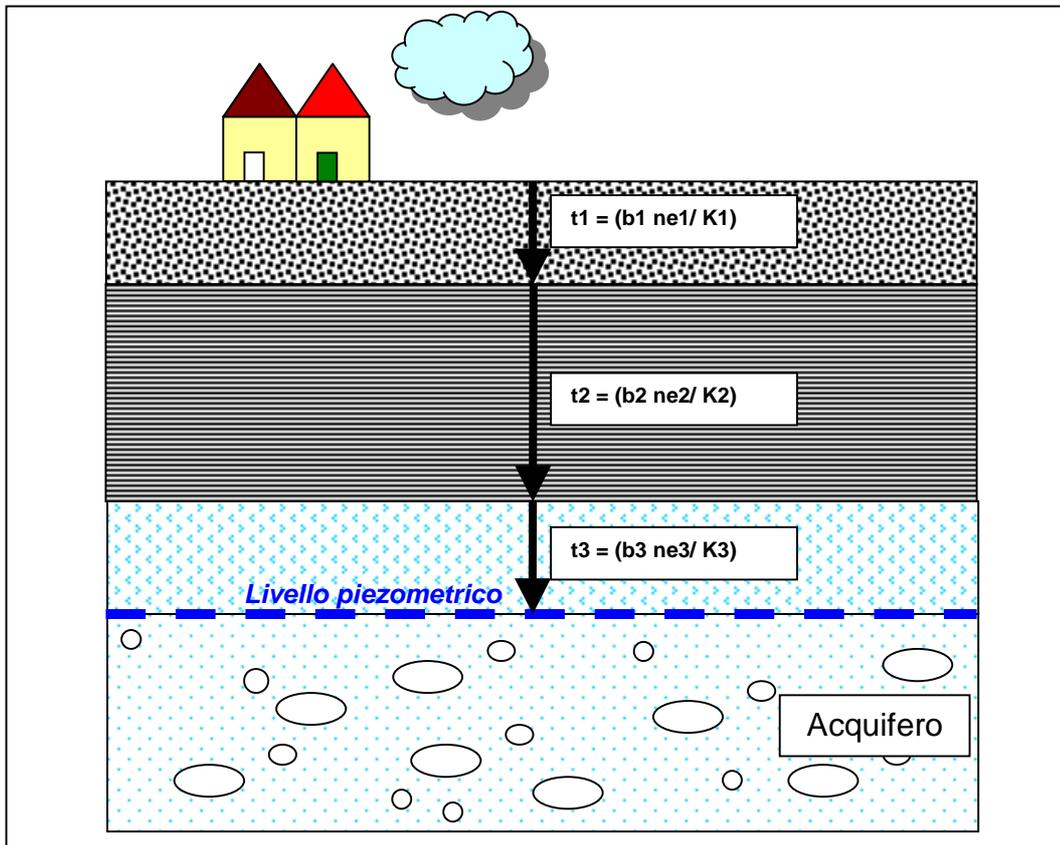
Rappresentazione schematica del calcolo del tempo di arrivo in falda di un inquinante idrotrasportato
