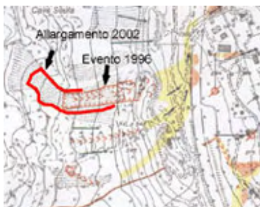
Autostrada A26 - Estratto dalla carta dei processi e degli effetti dell'evento alluvionale dell'8 luglio 1996 con sovrapposizione del limite approssimato dell'allargamento della frana
